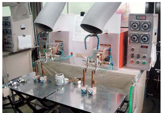
< 高周波熱処理機（銀ろう溶接） >
